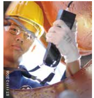
德尔格 X-am 5000 可选外置泵用于间隙测量
