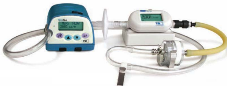
(使用 4146 现场校准 SP730 个体采样泵)
