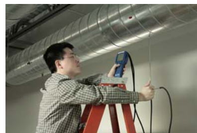
管道截面法测风量：毕托管
